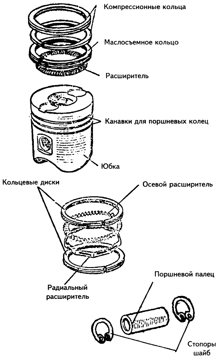
Рис. 5. Детали поршневой группы двигателя
