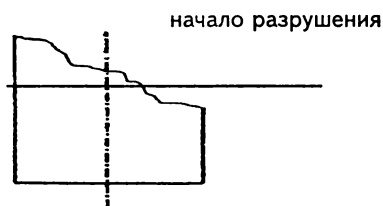
Рис. 154. Определение места начала разрушения по наклону излома относительно оси детали
